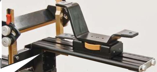
12-2. ガラスフレームの後ろに、図のようにレールとカメラ台を取り付けます
