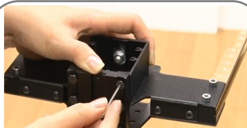
2. レールとガラスフレームを4つのねじで留めます。 ※向きに注意してください。
